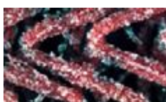
Зерна абразивного минерала на тканевой основе
